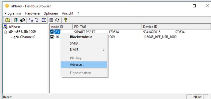
Nach Abschluss der Initialisierungsphase sucht das Programm isPlover den Bus nach angeschlossenen Feldgeräten ab und zeigt diese im rechten Teilfenster an. In der Detailansicht werden weitere Informationen wie z.B. die Device-ID oder das PD-Tag der angeschlossenen Feldgeräte gezeigt.
