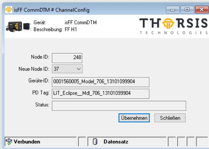
Mit Hilfe dieses ActiveX kann die Node ID eines Feldgerätes geändert werden. Dieses Menü ist nur für
