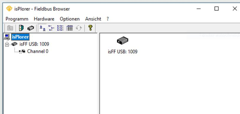
Bevor die Software gestartet wird, sollte man den isFF USB Adapter an den PC anschliessen. Nach dem anschließenden Start des isPlorer erscheint das Gerät links in einer Baumansicht zusammen mit dem zum Gerät gehörenden FF-Anschluss.
