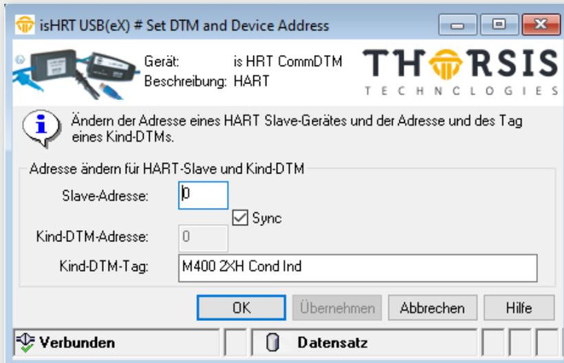
Die neue Adresse des Gerätes darf nicht in Benutzung sein und zur aktuellen Adresse dürfen keine Verbindungen von DeviceDTMs bestehen. Der isHRT CommDTM überprüft diese Voraussetzungen, bevor die Adressänderung vorgenommen wird. Ist eine dieser Voraussetzungen nicht erfüllt oder die Adressänderung schlägt aus anderen Gründen fehl, wird ein Fehler im Status-Feld angezeigt.
